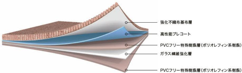
EcoWorx®は、PVCを使用していないバッキングです。リサイクル材を一部に使用したポリオレフィン系樹脂バッキングで、軽量で剥離強度に優れています。また、VOC(揮発性有機化合物)排出量が少ないため人体に与える有害な影響が少ないバッキングです。
