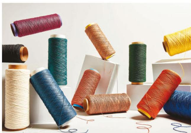
EcoSolution Q100ナイロンは、工場内端材を主原料とし、製造された原着ナイロン糸です。従来のカーペットと比較して、二酸化炭素排出量を削減することが可能で、色落ちしにくく、耐久性や耐候性に優れています。
