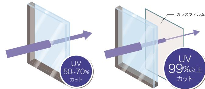
※紫外線透過率測定領域(300~380nm)の紫外線(UV-A, UV-B)を99%以上カットします。
