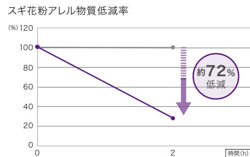
[試験方法]ダニならびにスギ花粉アレル物質溶液を壁紙表面に接触させ、2時間後のアレル物質残存量をELISA法にて測定する。
