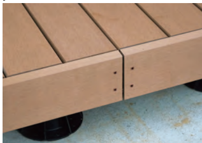
床板と同じ継ぎ目デザインにすることでより自然な形に。 5mm以上の透かしを入れることを推奨しています。
