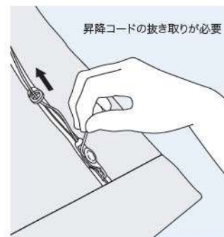
一般的な昇降コードの取外し
