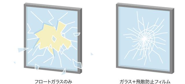
JIS A 5759 飛散防止性能試験A法(ショットバッグ試験 イメージ図)
