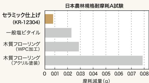
試験片を1kgの研摩機で研摩回転させて、500回転後における試験片の表面変化と100回転あたりの摩耗減量を求めます。
