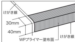
図の斜線部の下地に、WPプライマー(BB-613)をハケで均一に塗布し、30分程度乾燥させてください。WPプライマー塗布面は、汚さないように注意してください。
