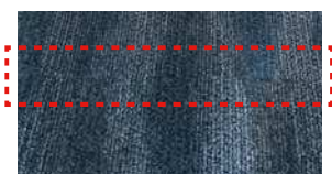
タテリピートを合わせてジョイントした場合 ※柄が正確には合いません。
