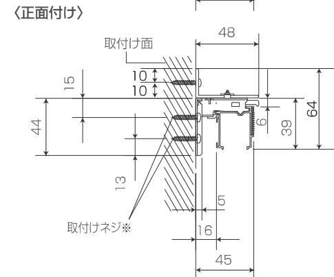
※取付けネジは下地位置の状況に応じて図のどちらかの位置に取付けてください。
