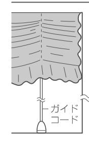
※正面付けの場合は、ガイドコード止め金具をガイドコード取付けネジ(ナベφ3×20)2本で取付けてからコード止め下をガイドコード固定ネジ(ナベφ4×6)で取付けてください。
