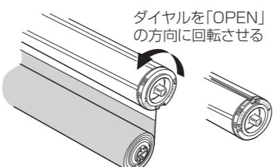
ダイヤルを「OPEN」の方向に回転させる
