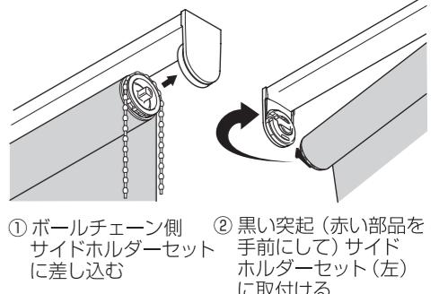
次にスクリーン本体の黒い突起を、赤い部品が手前側に見えるように、サイドホルダーセット(左)に取付けてください(②)。スクリーン本体がきちんと納まつたら、ダイヤルを「CLOSE」の方向に止まるまで回してください(③)。
