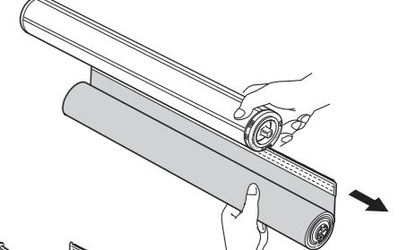
⑦最後にウエイトバーキャップの片側を外しウエイトバーをスクリーンから抜き取ってください。
