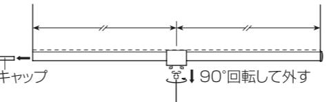
②本体下に付いている、止め具を90°回転して取外し、本体をウエイトバーキャップの外した方へずらして、ウエイトバーから抜き取ります。その際、本体でスクリーンを引っ掛けないようご注意ください。
