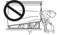
（） 製品は製品高さ以上にスクリーンを引き出さないでください。スクリーン及びその他部品の落下、破損の原因になります。
