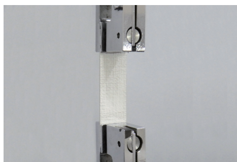
テンシロン型引張試験 (※壁紙での参考画像です。)
