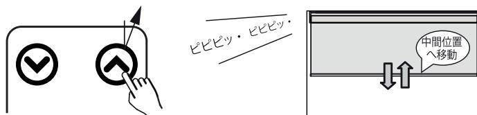
※「位置設定モード」に入ると、「長押し」操作ではスクリーンの昇降速度は低速回転となります。
