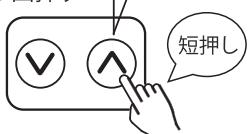
スクリーンを上げるときは右の『△』ボタンをポンと短く1回押します。自動で全開位置まで移動し止まります。
