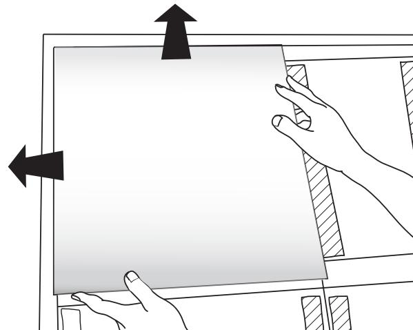
5 最上段の一枚を納めた後に、隙間が生じないよう、縦一列ごとに納めていきます。
