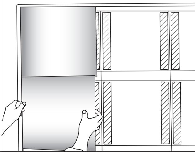
6 施工途中で隙間が発生した場合は、都度調整して下さい。(マジックテープ止めですので何度も調整が可能です)
