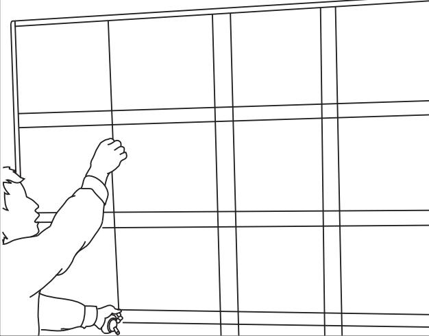
2 パネル裏面のテープ位置を確認して、割り付けした壁側へマジックテープを貼り付けます。必要に応じてタッカーなどを使用して固定します。(両面テープは製品に同梱されています)
