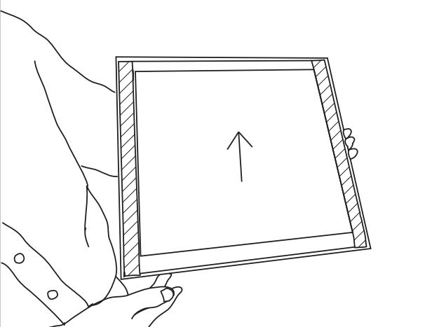
4 施工箇所のコーナーから納めていきます。隙間が生じないように、矢印方向に力を入れて貼り付けます。
